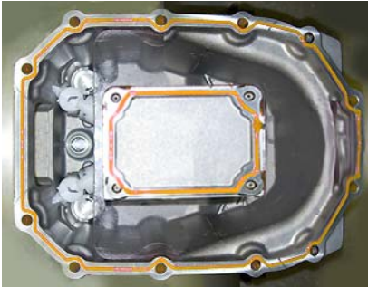
Kleberauftrag auf einer Serien-Baugruppe
