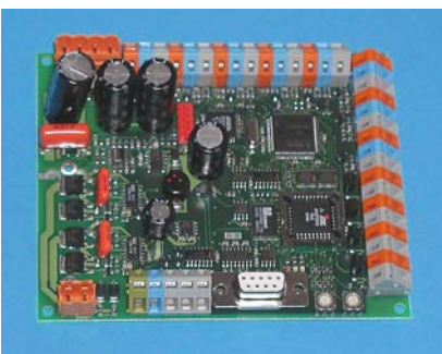
MK-48-5: Platine im Eurokartenformat mit Bohrungen zur Befestigung mit Abstandsbolzen.
